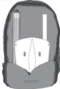
Durch die Position des Schaufelblatts in diese Richtung werden die Abnutzung des Rucksackbodens durch die Kante des Schaufelblatts und der Druck auf das Aufblasystem sowie auf den Inhalt des Rucksacks reduziert.
