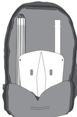
Ved å plassere spaden i denne retninga reduseres slitasjen på undersiden av sekken fra spadeeggjen, og fjerner trykkpunkt på utløsersystemet og innholdet i sekken.
