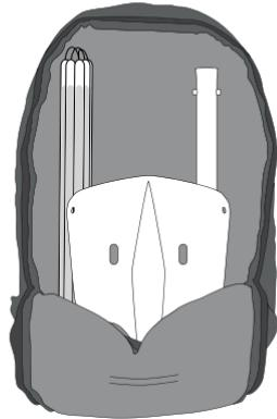
Introducir la pala en esta dirección reduce el desgaste del fondo de la mochila por el filo de la pala, y elimina un punto de presión en el sistema de inflado y en los contenidos de la mochila.
