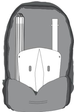
Placering av bladet i denna riktning minskar slitagelet av eggan på botten av ryggsäcken, och avlägsnar tryck på uppblåsingssystemet och ryggsäckens innehåll.
