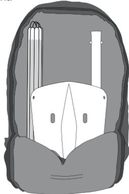
La position du godet de la pelle dans ce sens réduit l'usure du fond de sac par le tranchant du godet et enlève un point de pression sur le système de gonflage et le contenu du sac.
